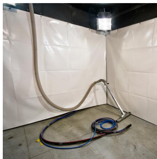
Pneumatické odsávání hubicí
