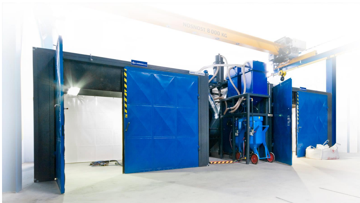
Dvojitá komora 3 x 4 m umožňuje tryskat zároveň dvěma abrazivy (např. korundem a skleněnou balotinou).
