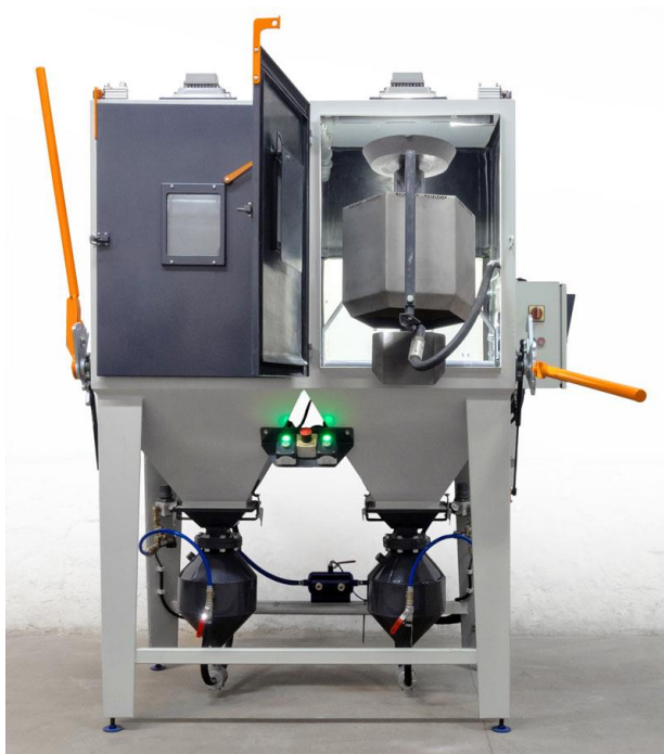
Dvojhubnový tryskač s ručním vyklápěním pákou
