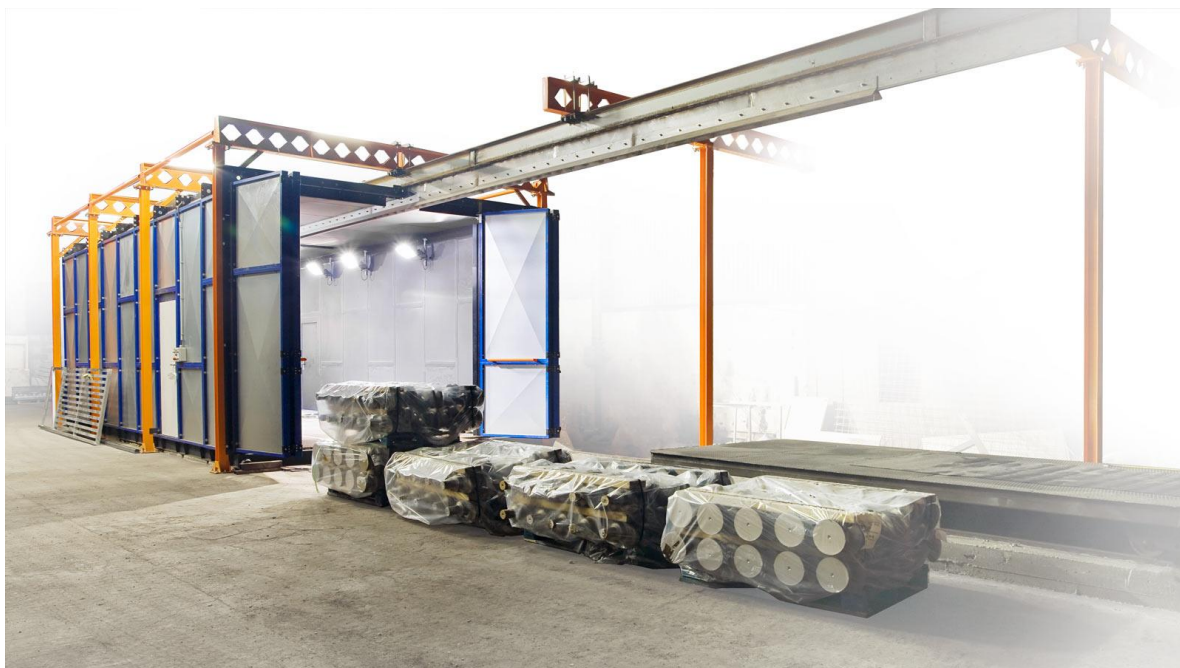
Tryskací komora 10 x 5 metrů se zavážecím vozíkem a závěsnou pojezdovou drážkou (do 1 t). Hrablová doprava materiálu.
