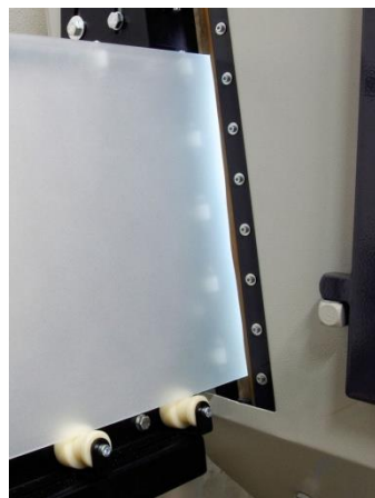
Průjezd kabinou po válečkové dráze
