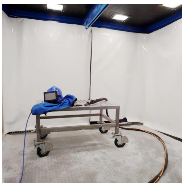
Interiér komory s pneumatickým odsáváním.
